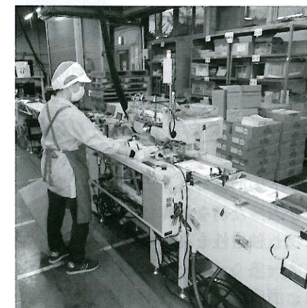
定形外サイズの封筒にも対応した特殊な封入・封函機
